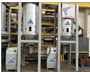
800 litre hopper with D250 55-150 deg C
